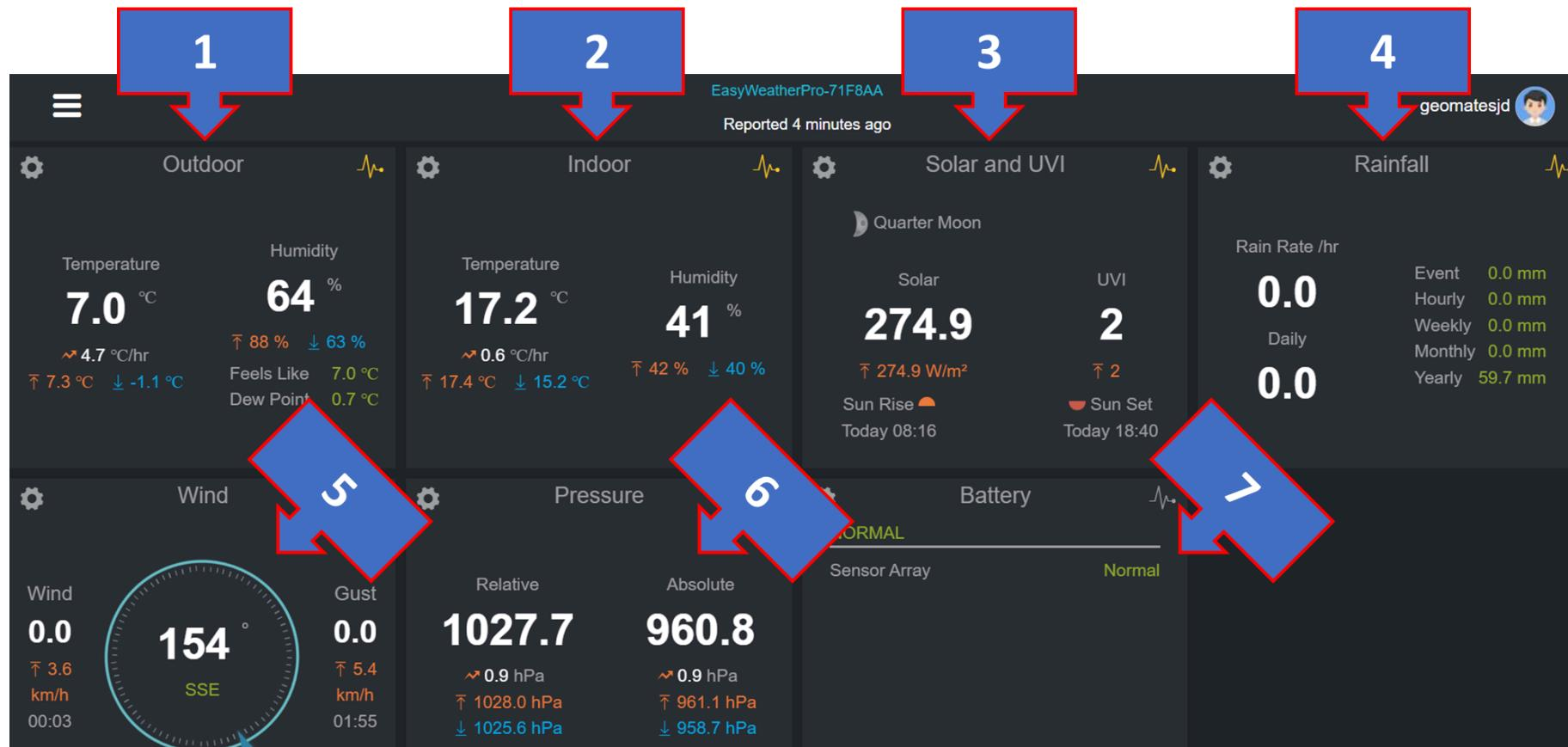
**1. Temperatura y Humedad Exterior:** nos muestra los datos del exterior (en la localización de la estación). Temperatura actual, máxima y mínima diaria, sensación térmica, humedad, punto de rocío...
